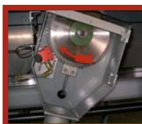
Sägeblatt in der Werkzeugwechselposition, mit Feststellbolzen und Sprühvorrichtung (Option)
