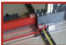
Patentierter Niederhalter hält das Werkstück beim Sägen fest und verhindert Verletzungen
