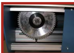
Sägeblatt in der Werkzeugwechselposition, mit Feststellbolzen
