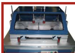
Spannsystem und Schutzhaube, hält das Werkstück beim Sägen fest und verhindert Verletzungen
